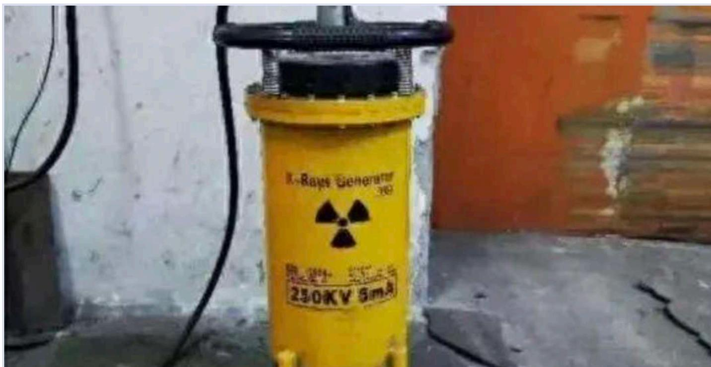
陈姓工人使用的仪器，主要用于检测焊接过的金属器件是否完好或有损伤
